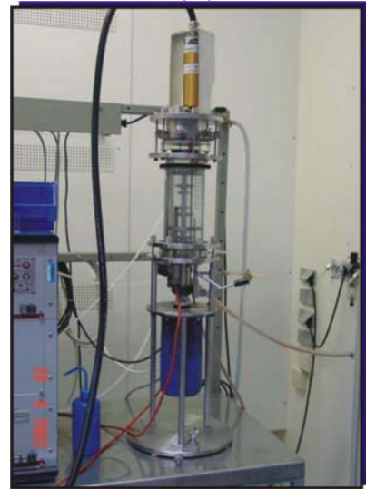
Fig.14: Installation d'un capteur sur un bioréacteur
