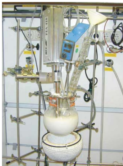
Fig. 11: Mesure 'In Situ' d'une distribution en taille de bulles pendant une polymérisation
