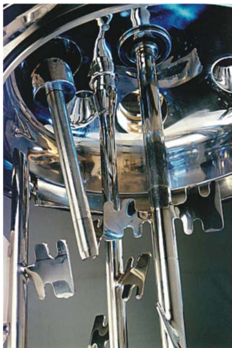
Fig. 10: Sonde 'en ligne' installée dans un homogénéisateur Vakumix
