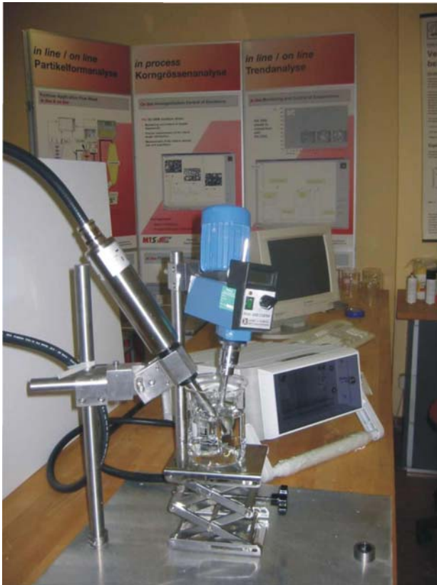
Fig. 9: Installation d'un essai d'étalonnage de l'affichage du MTS en laboratoire
