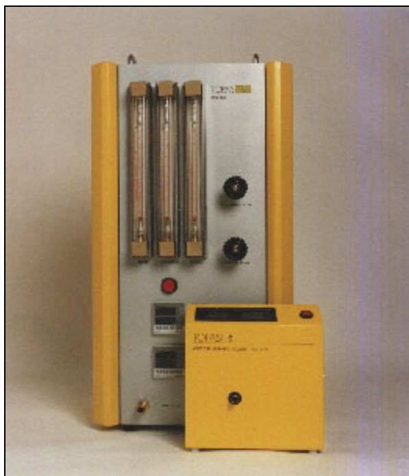
Contrôle d'aérosols mono dispersés produit par le générateur d'aérosol par condensation SLG 270
